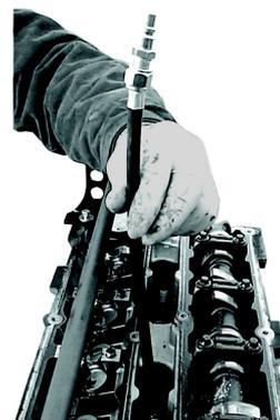
7. Mettere la leva (1) con uno dei due intagli (4) sotto l'asta rotonda, assicurarsi che l'adattatore perpendicolare della molla valvola prema la molla valvola.
